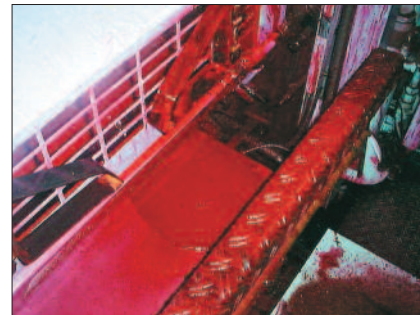
Des protège-mains encrassés et mal positionnés favorisent l'égouttement de l'encre et provoquent du maculage et des casses de la bande. Photo manroland.
