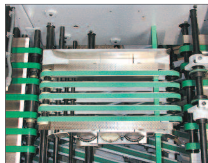
Vérifier régulièrement que les courroies ne soient ni usées ni craquées et qu'elles soient correctement tendues. Un défaut de tension réduit la transmission de puissance, une tension excessive peut endommager les moteurs d'entraînement.
