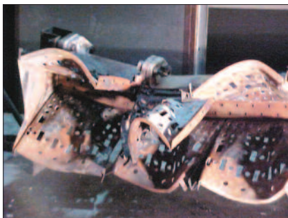
Un défaut de maintenance du brûleur ou un réglage incorrect du mélange air-gaz peut détruire le brûleur. Photo MEGTEC.
