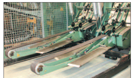
Nettoyer les courroies de guidage du bras oscillant pour éviter l'endommagement des courroies de tension.
