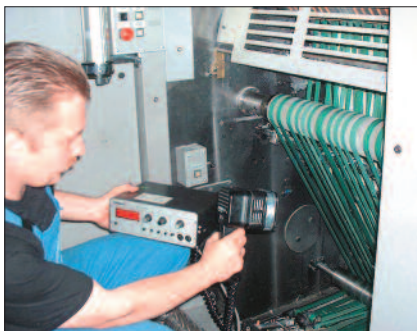
Le stroboscope est un outil utile pour l'identification des problèmes de fonctionnement sur les équipements en mouvement. Photo manroland.
