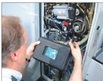
Certains imprimeurs communiquent avec les services de télémaintenance de leurs fournisseurs, grâce à Internet et un système de caméras numériques sans fil, pour identifier et résoudre plus rapidement les problèmes en cours de production. Cet exemple est tiré de ServiceVision de manroland.
