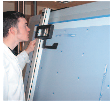
L'inspection de la plaque fait partie des contrôles clés pour réduire les temps d'immobilisation de la presse. Photo KPG.
