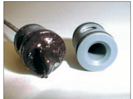
Buse d'injecteur contaminée par l'encre suite à l'utilisation d'un filtre inadapté ou à un défaut de maintenance. Photo Technotrans.
