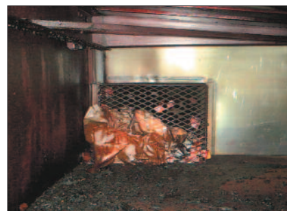
Si le papier adhérent au tamis des filtres n'est pas enlevé, il risque de brûler et de se désagréger en fines particules, provoquant un incident au niveau du manostat, l'arrêt de la production ou de la condensation. Photo MEGTEC.
