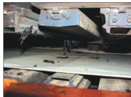
Les accumulations d'encre et de papier peuvent former des amas durs et tranchants qui, projetés par les fentes des barres d'air, occasionnent maculage et casse de la bande. Photo MEGTEC.
